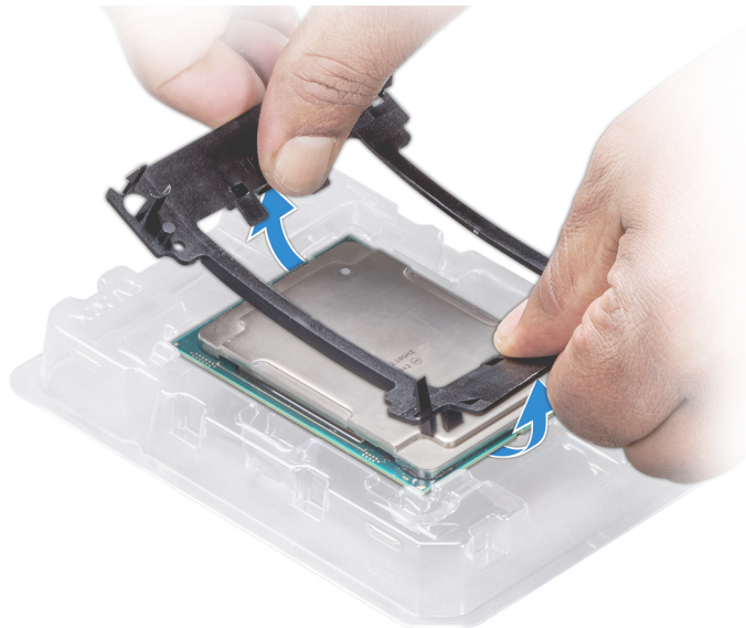
Ilustración 49. Extracción del soporte del procesador
