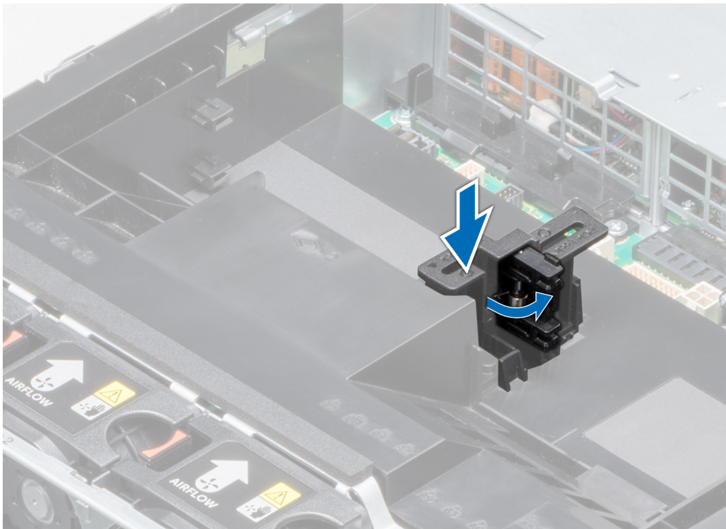
Ilustración 54. Cómo abrir el pestillo del soporte de tarjeta PCIe
