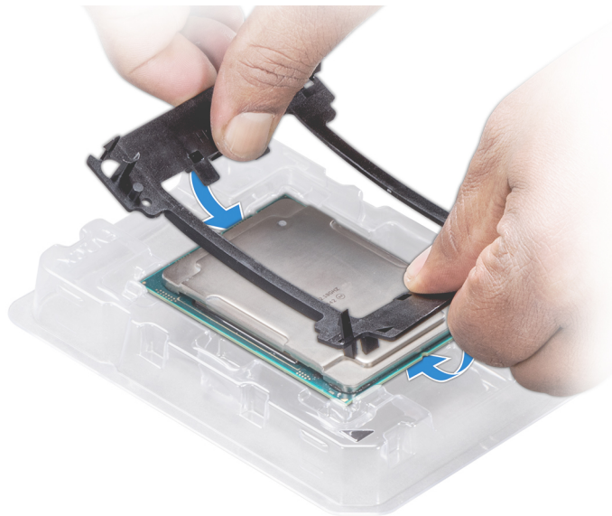
Ilustración 50. Instalación del soporte del procesador
