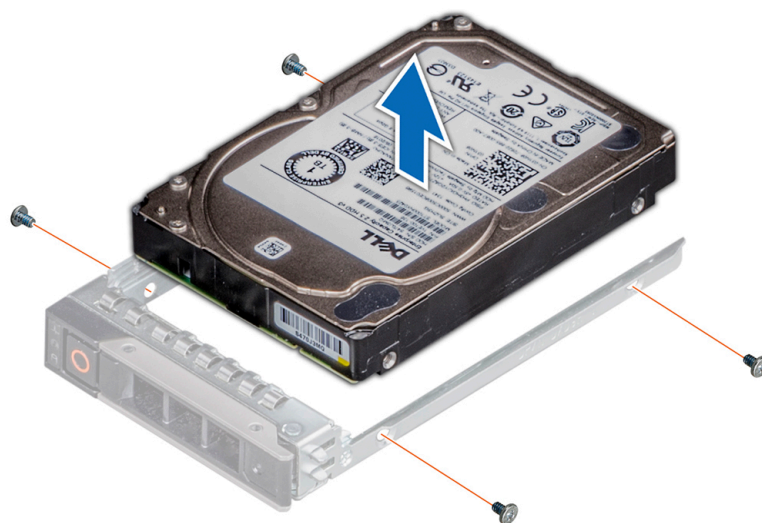
Ilustración 40. Extracción de la unidad del portaunidades
